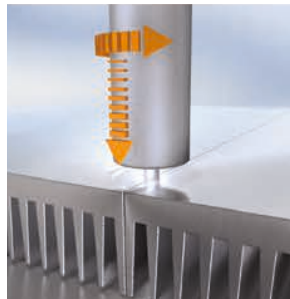
Werkzeug taucht in Kühlkörper ein
