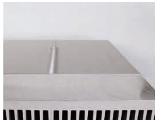
Keine sichtbare Schweißnaht nach dem Überfräsen
